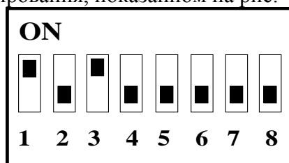
Рис. 4. Пример установки адреса БУСО
